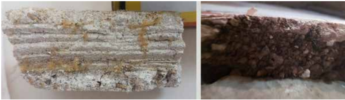
Сл. 12 - Споредба на малтерна основа во слоеви: а) - над дрвена подлога од плацки; б) - над камена основа (примероците се земени од црквата Св. Стефан, с. Конопиште и Св. Димитрија, с. Драчевица, од сводните фрески на плацки од катната галерија и од страничниот северен ѕид во катната галерија (фотографији од А.Поповска-ИКОМОС Мк)
